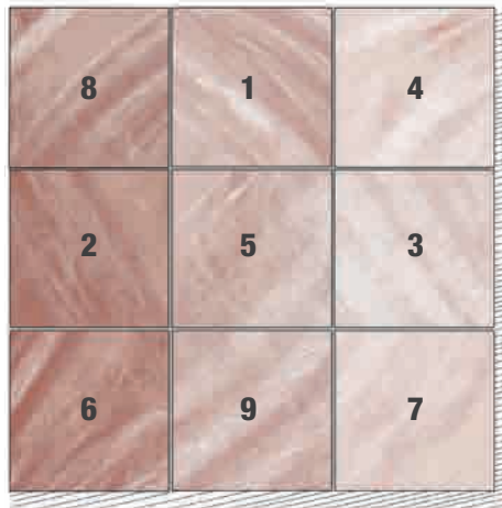
Verlegung nach Farbe und Struktur.
